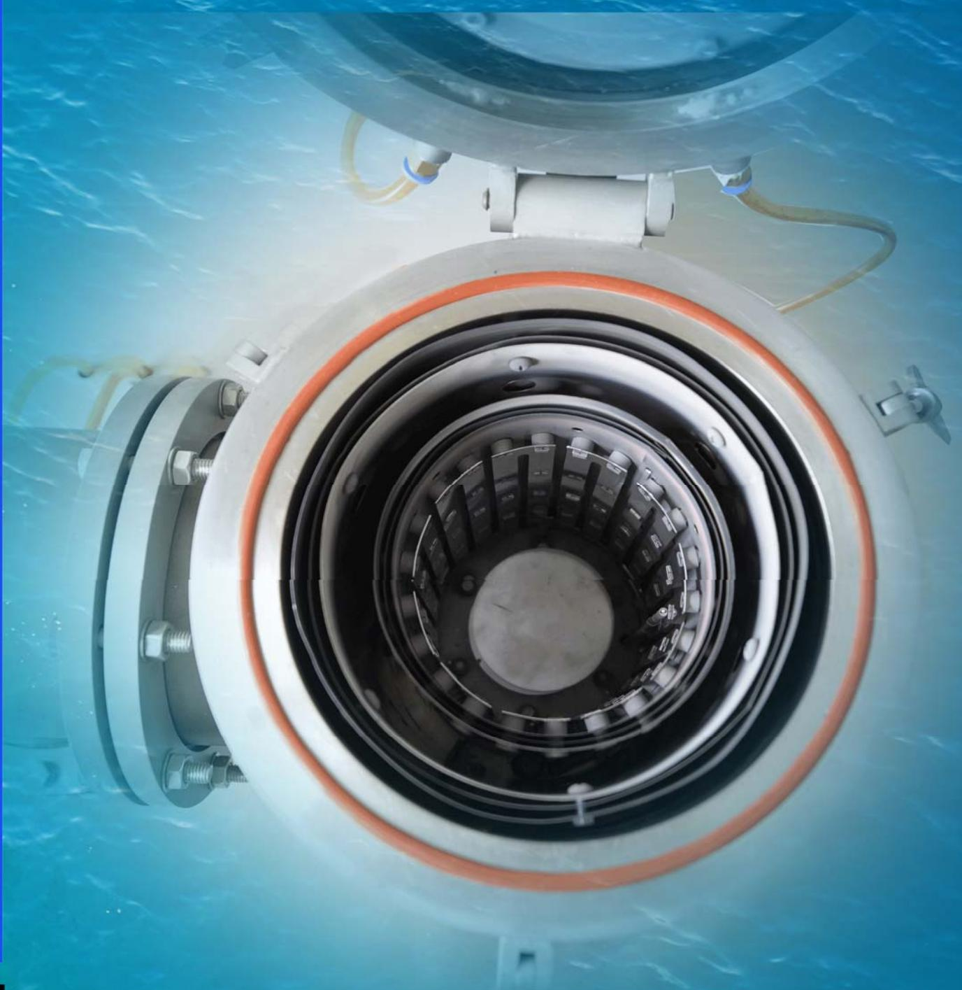
CZL 程控式真空钎焊炉
